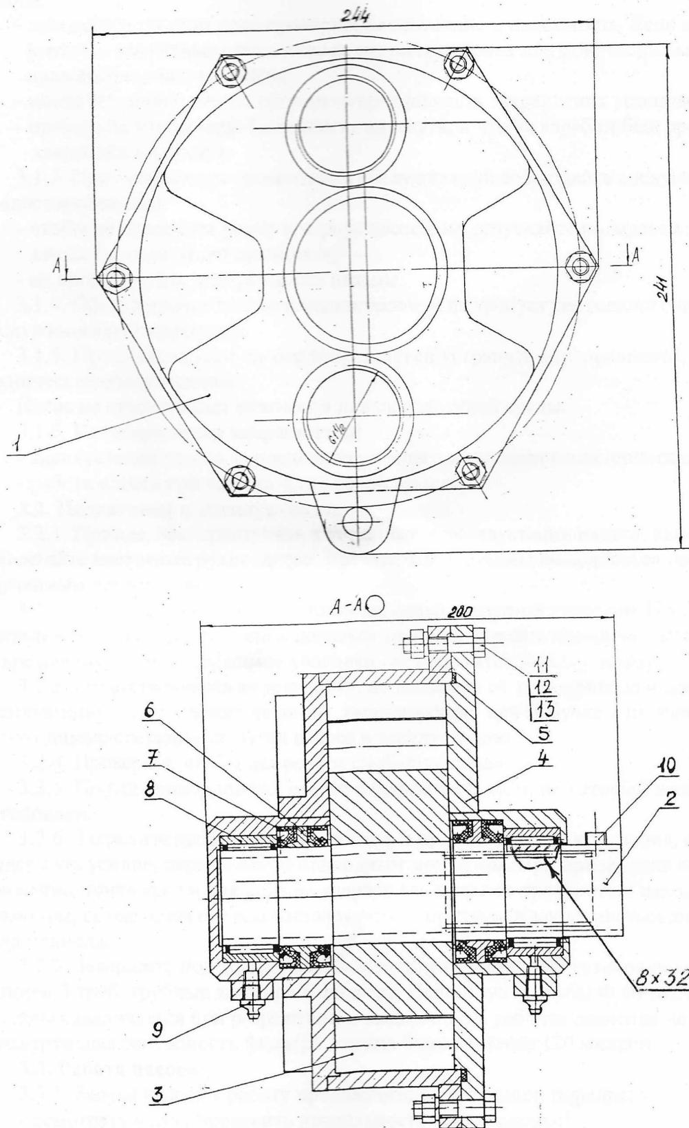
Рис.1. Насос роторный НР-300. Общий вид.
